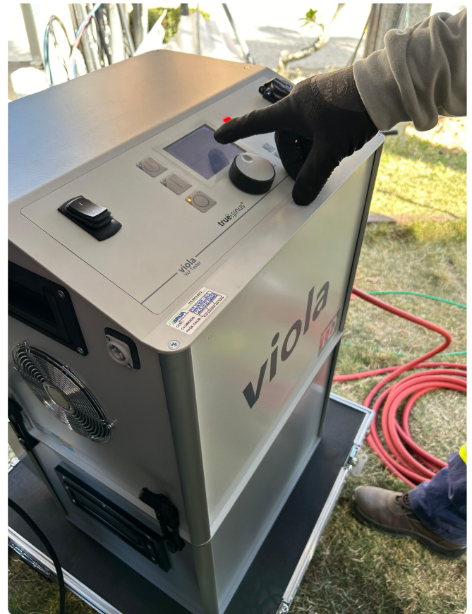
Painel do equipamento de ensaio VLF (forma de onda senoidal) em operação. Imagem ilustrativa.
